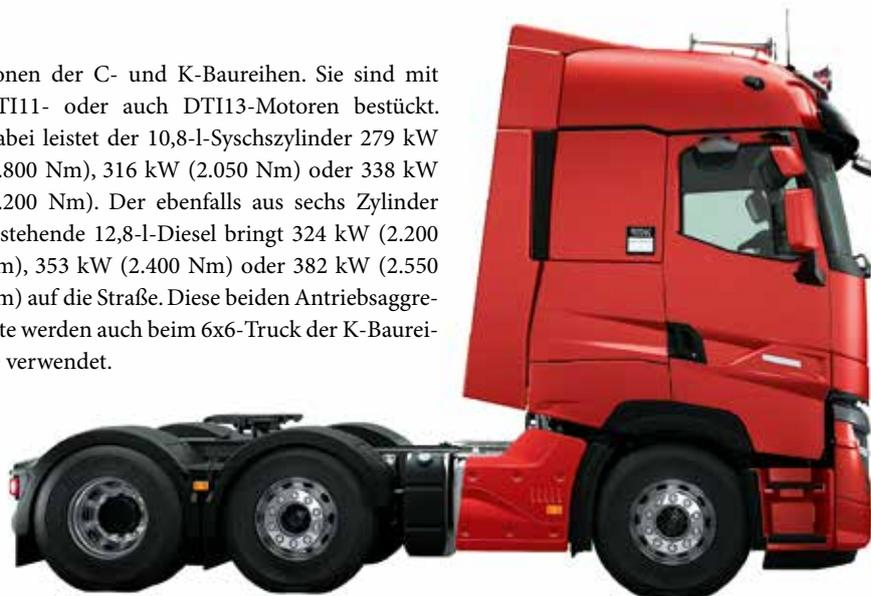
Der Renault T (High)-Truck 6x2 kann sowohl mit dem DTI11- als auch dem DTI13-Motor geordert werden.
