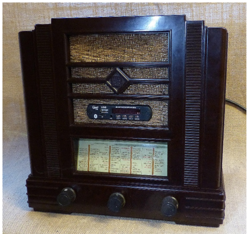
Der umgerüstete „Telefunken Nauen 330WL“
