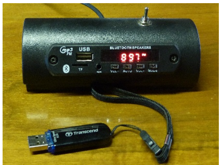
Bluetooth-MP3-UKW - Modul in extra Gehäuse eingebaut, auf dem Radio stehend
