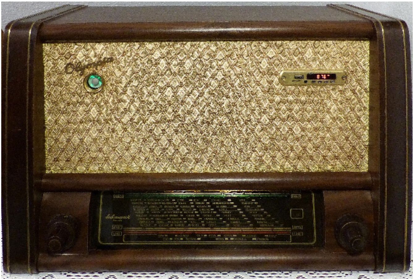
Bluetooth-MP3-UKW - Modul farblich angepasst und eingebaut.
