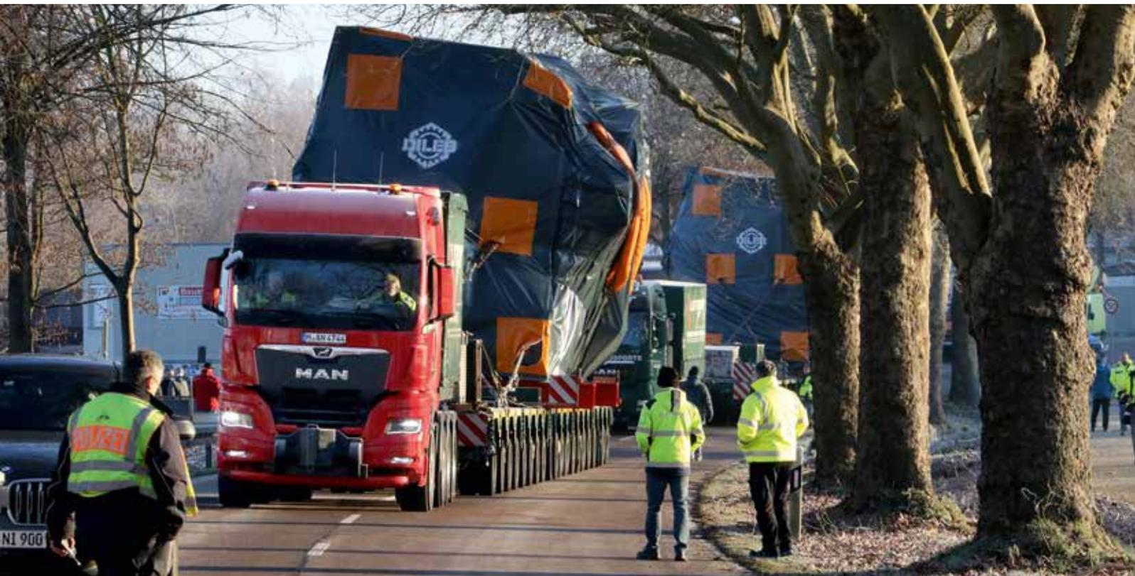
Bei diesem Schwertransport kommt eine MAN-Sattelzugmaschine mit vier Achsen zum Einsatz.
